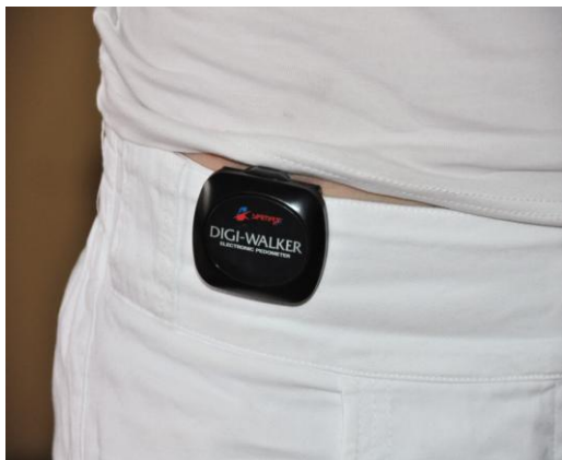
Obr. Umístění pedometru při měření
