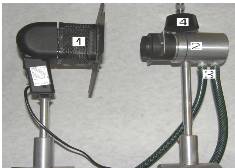
Obr. 6: Optická hlavice pro ozařování vzorku v kyvetě; 1 - halogenová lampa, 2 - ocelový kyvetový držák, 3 - vodní chlazení, 4 - magnetické míchání
