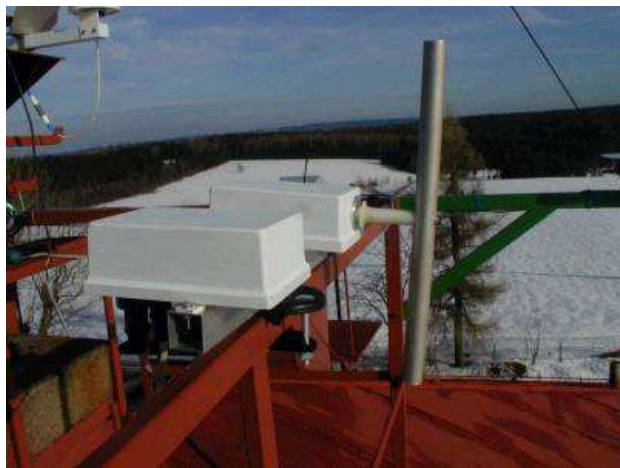
Obr. 3. Námrazoměr vyvinutý v Ústavu fyziky atmosféry AV ČR (Internet 2)
