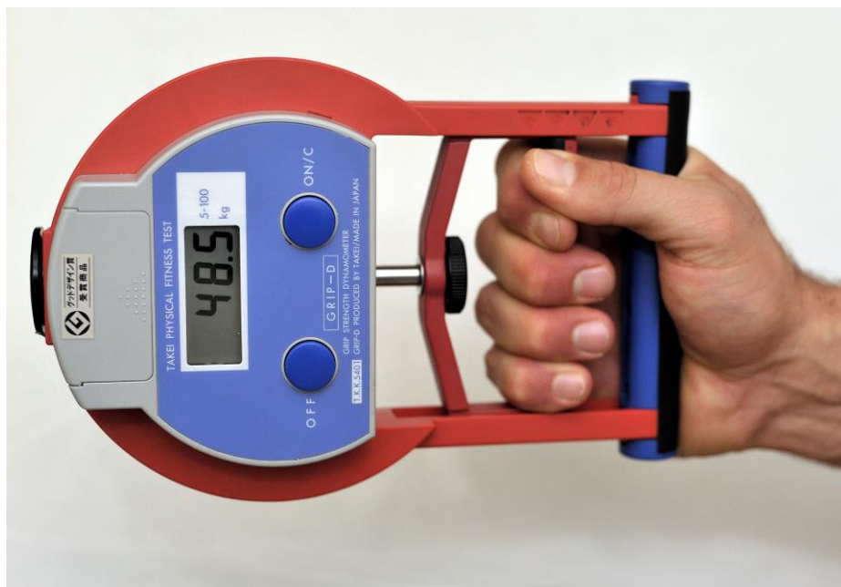
Obrázek 8. Ruční dynamometr pro měření síly stisku ruky
