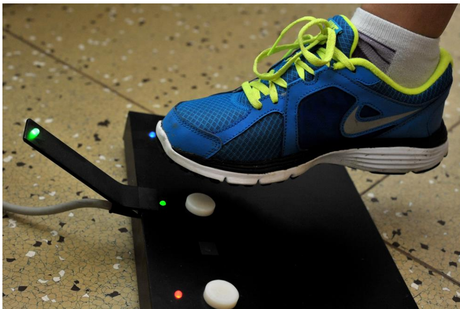
Obrázek 7. Zařízení na měření reakční doby dolní končetiny na vizuální podnět
