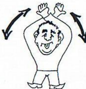
9/ Porucha během provozního postupu, přerušte provozní postup! Zkřížené paže nad hlavou.
