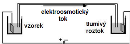
Obrázek 4 Schéma elektrokinetického dávkování; převzato z [5] a upraveno.
