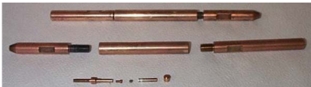
Obr. 3.11: Svěrací tlaková cely pro měření ACMS v aparatuře SQUID použitá pro měření za vysokých tlaků.
