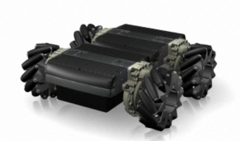
Obrázek 3.11: Čtyřmotorový všesměrový robot Segway se koly umožňujícími volný pohyb pod úhlem 45^\circ resp. -45^\circ . Převzato z [12].
