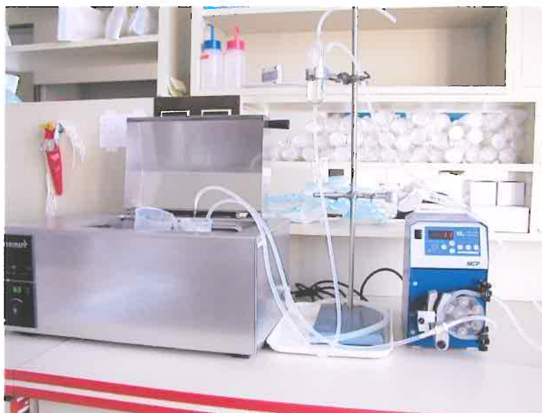
Obr. 16: Aparatura pro izolaci hepatocytů: Vodní lázeň zahřátá na 37 °C, ve které jsou umístěny kádinky s izolačními roztoky. Zásobník izolačních roztoků, který je umístěn asi 40 cm nad kádinky s izolačními roztoky, kvůli zajištění přiměřeného perfuzního tlaku. Peristaltická pumpa, napojená mezi kádinky s roztoky a zásobníkem roztoků, tlaková nádoba obsahující karbogen, která je hadicí (silikon, Ø 5 mm) spojena se zásobníkem izolačních roztoků. Probubláváním karbogenem je zajištěno dostatečné množství kyslíku v médiu. Hadice (silikon, Ø 5 mm) přivádějící roztoky z baňky do kanyly umístěné ve v. portae . Přepadová hadice (silikon, Ø 5 mm), která odvádí roztoky ze sběrné baňky do kádinek ve vodní lázni.
