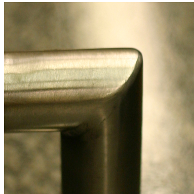
Obrázek 4.4: Využití rozpadů průniku rotačních singulárních kvadrik v technické praxi–spojovací potrubí.
