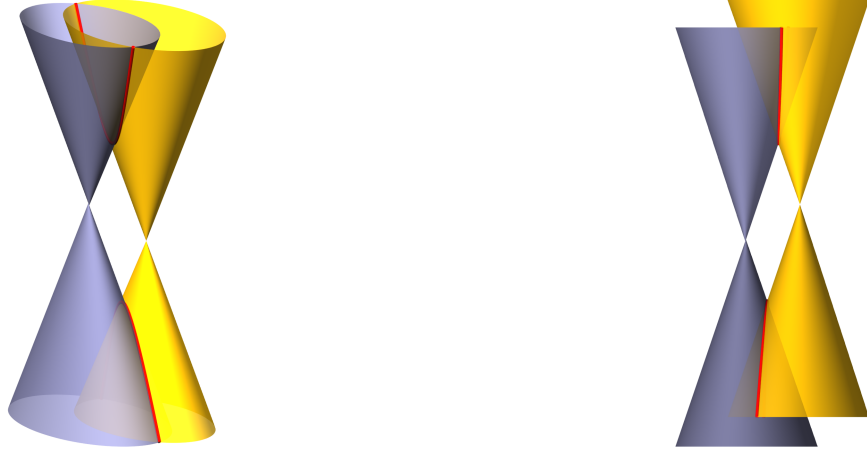
Obrázek 3.8: Dva posunuté kužele. Dva pohledy na kvadriky z Příkladu 3.14 a jejich průnikovou křivku – dvě kuželosečky. Tyto kužele mají rovnoběžné osy a jsou shodné, proto mají společnou nevlastní kuželosečku. Druhá část průnikové křivky těchto kuželů neleží v rovině rovnoběžné s jejich povrchovou přímkou.
