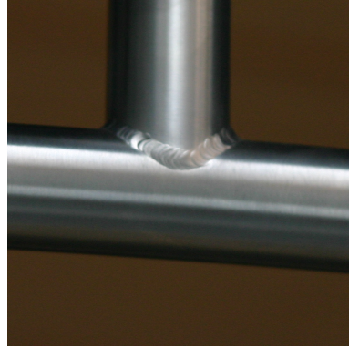
Obrázek 4.3: Využití rozpadů průniku rotačních singulárních kvadrik v technické praxi–rozvětvené potrubí.
