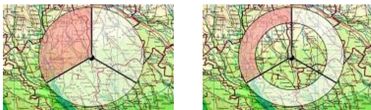
Obr 13. Určení sektoru oblasti pomocí jedné BTS a hodnoty TA (URL 15 )
