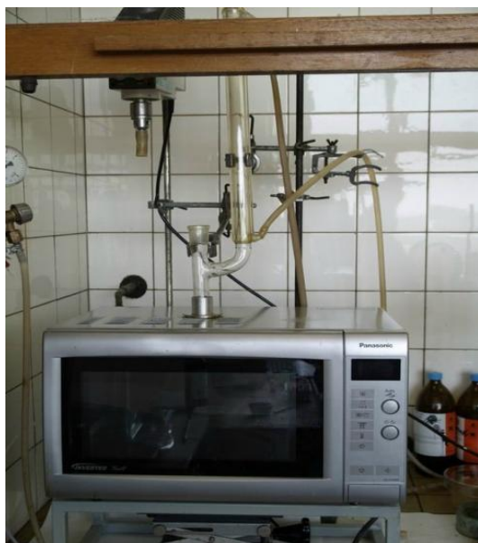
Obr. 10 Upravená mikrovlnná trouba Panasonic NN-GD566M ( f = 2,45 GHz) na ÚMCH AV ČR
