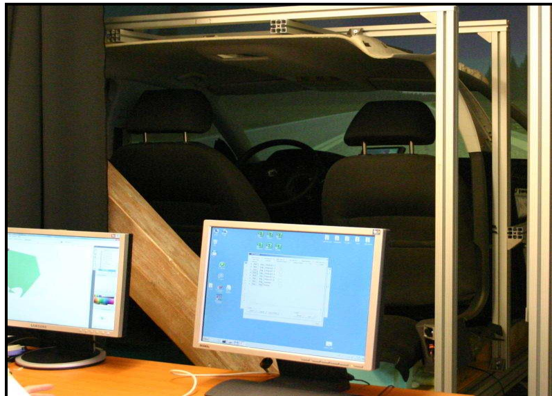
Obr. 14: Simulátor jízdy (foto:FD ČVUT)
