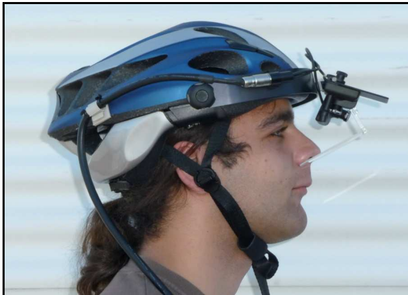
Obr. 19: Řidič s eye-trackerem na hlavě (foto:autor)
