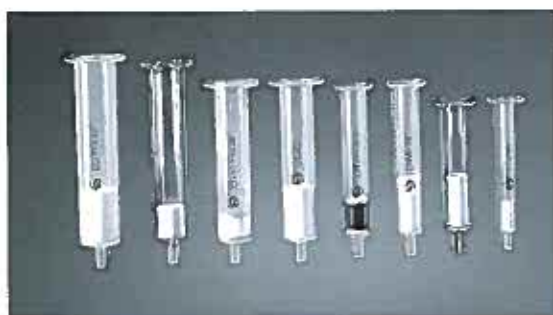
Obr. 4 kolonky se sorbentem pro SPE, sorbent je uložen v trubičkách z polypropylenu nebo ze skla
