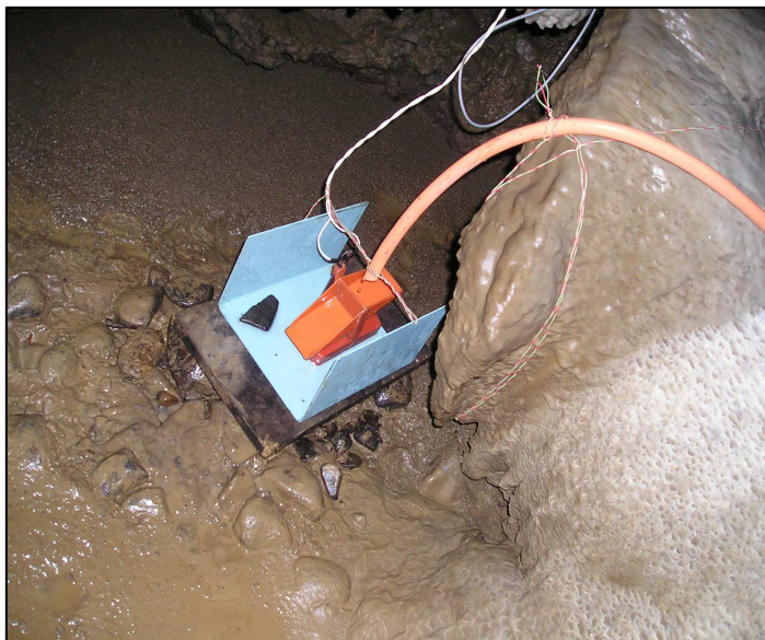
Obr. 4.2 Zařízení k měření průtoku – „sklopka“ (výroba M. Jež, foto. P. Vysoký)
