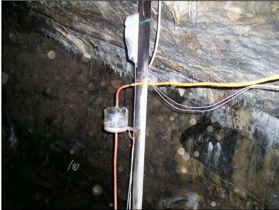
Obr. 3.8 Skapové místo E2 (hadička od stropu) a sklopka k měření průtoku skapového místa E' (přívodní hadice jde ve směru od místa E)
