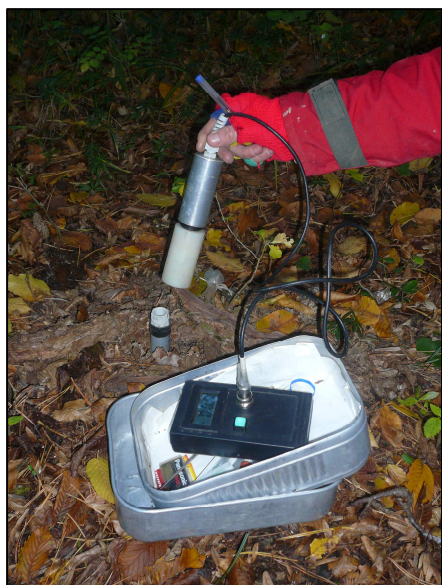
Obr. 4.1 Měření sacího tlaku na tenzometru. (foto J. Kamas)
