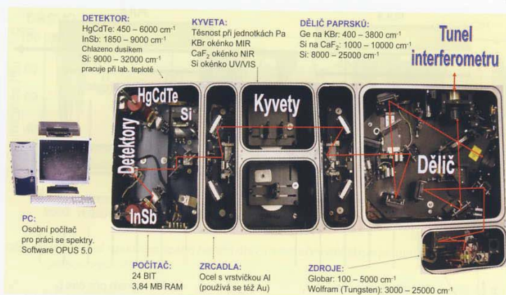
Obr. 2 Řez spektrometrem Bruker IFS 120 v absorpčním uspořádání s charakteristikami jednotlivých komponent
