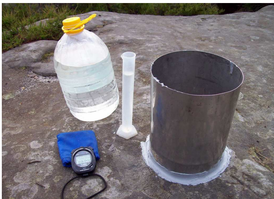
Obr. 5.5.: Infiltrační zkouška na povrchu pískovce v klokočských skalách
