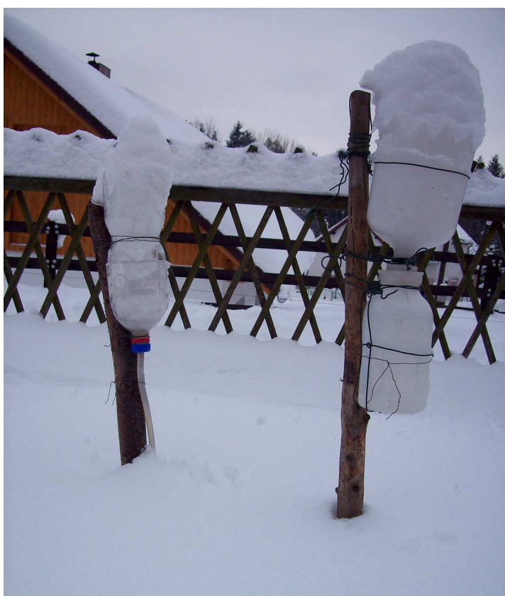
Obr. 7.2.: Srážkoměry zanesené sněhem v únoru 4.2.2010
