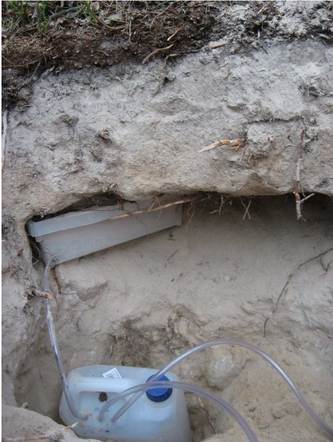
Obr. 5.3.: Instalace půdního lyzimetru LC
