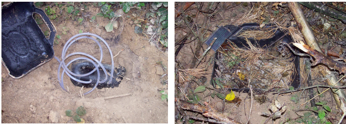
Obr. 5.2.: Povrchový lesní srážkoměr LE
