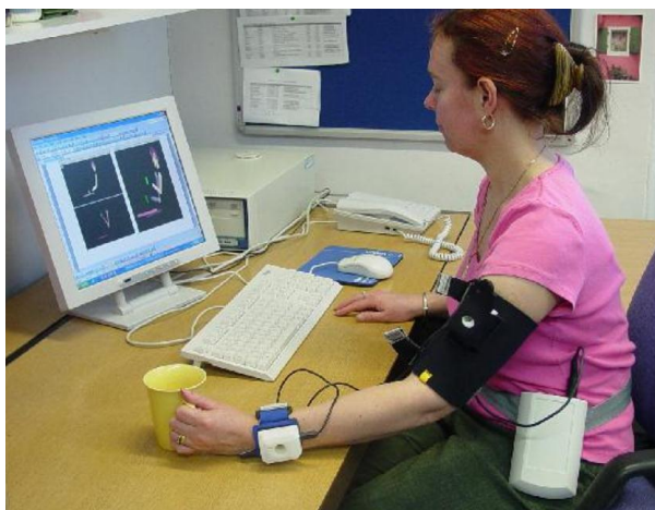
Obr. 2: Ukázka pomůcky s inerciálními senzory k měření pohybu paretické HK [38]
