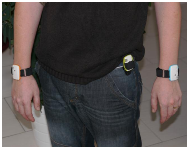
Obr. 5: Umístění senzorů na tělo monitorované osoby [41]
