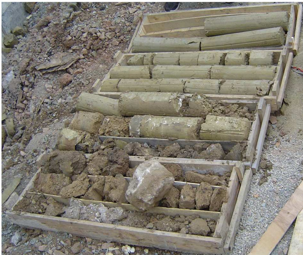
Obrázek 5: Vrtné jádro z vrtu J1. Je seřazeno po metrových částech dle hloubky. V pravém spodním rohu fotografie je nesvrchnější část jádra. (fotografii poskytl Rott, 2011).
