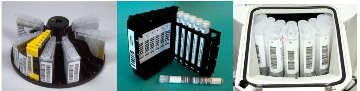
Obrázek číslo 9: Immulite®2000 – zásobníky antisér, alergenů a reakčních kuliček
