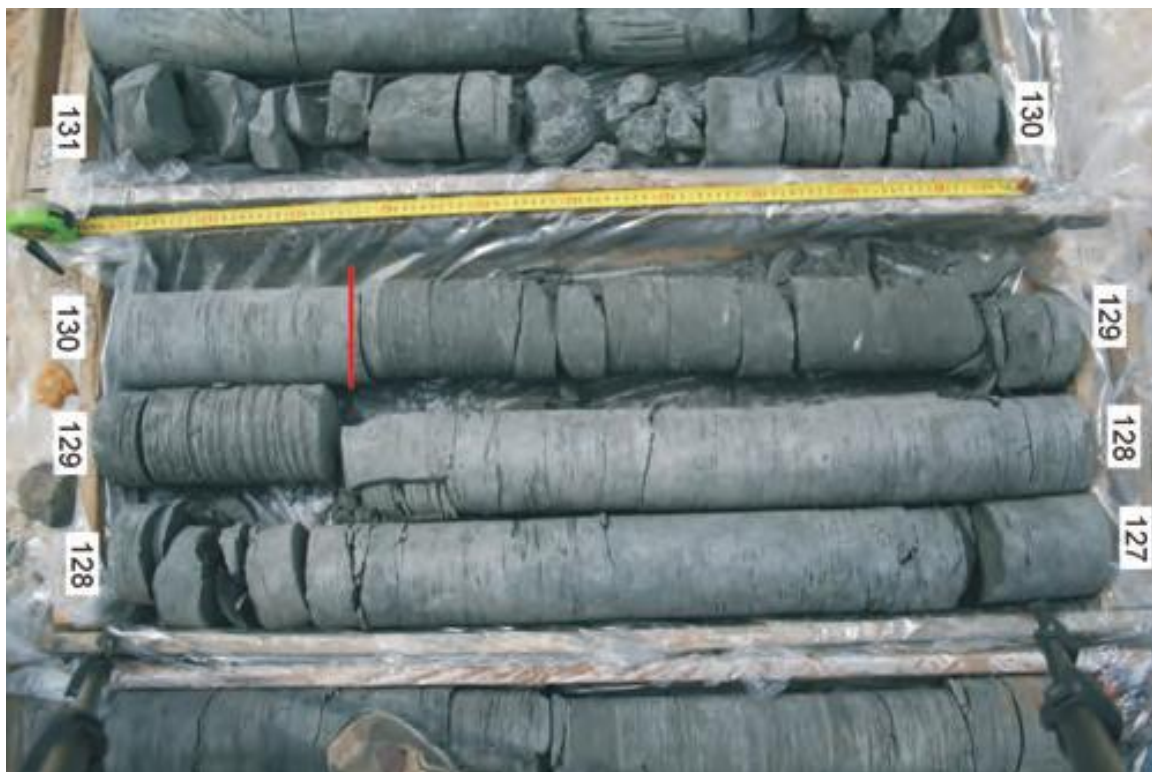
Obr. 11. Báze aleuropelitů teplického souvrství v metráži 129,77 m (vznačeno červeně). Vrt V 800. Foto S. Čech (Čech et al. 2011).
