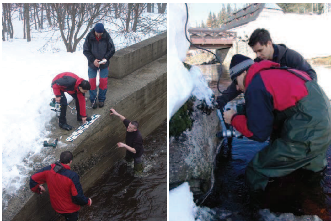
Obr. 22 Instalace vodočetných latí v profilu Křemelná – nad soutokem s Prášilským potokem a v závěrovém profilu Roklanského potoka (foto: autor)
