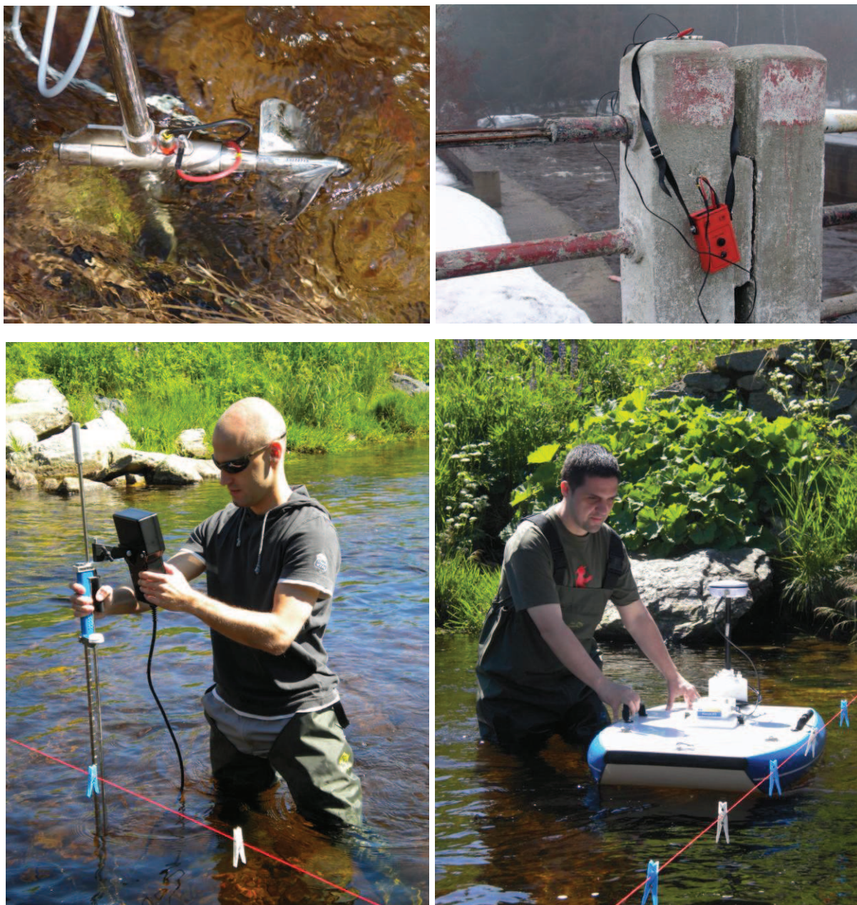
Obr. 31 Propeler hydrometrické vrtule (vlevo nahoře) a mechanické počítadlo otáček (vpravo nahoře), hydrometrování průtokoměrem FlowTracker (vlevo dole) a systémem ADCP (vpravo dole)
