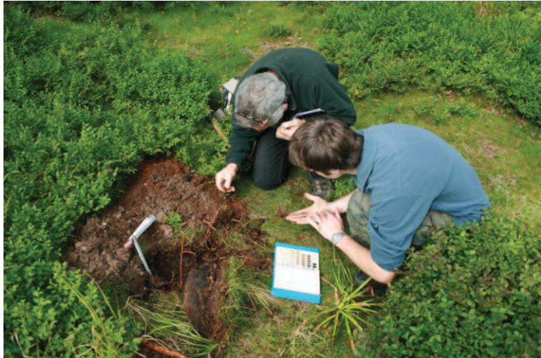
Obr. 35 Popis jednotlivých půdních horizontů v oblasti Rokyteckých slatí (foto: autor)
