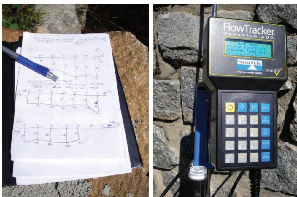
Obr. 10.2 Modernizace záznamového zařízení pro veličiny měřené v rámci hydrometrování: rok 2006 (vlevo), rok 2012 – FlowTracker (vpravo)
