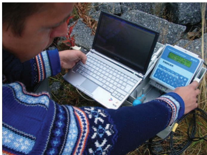
Obr. 26 Parametrizace měřících kanálů v rámci automatické stanice na Březníku (foto: autor)
