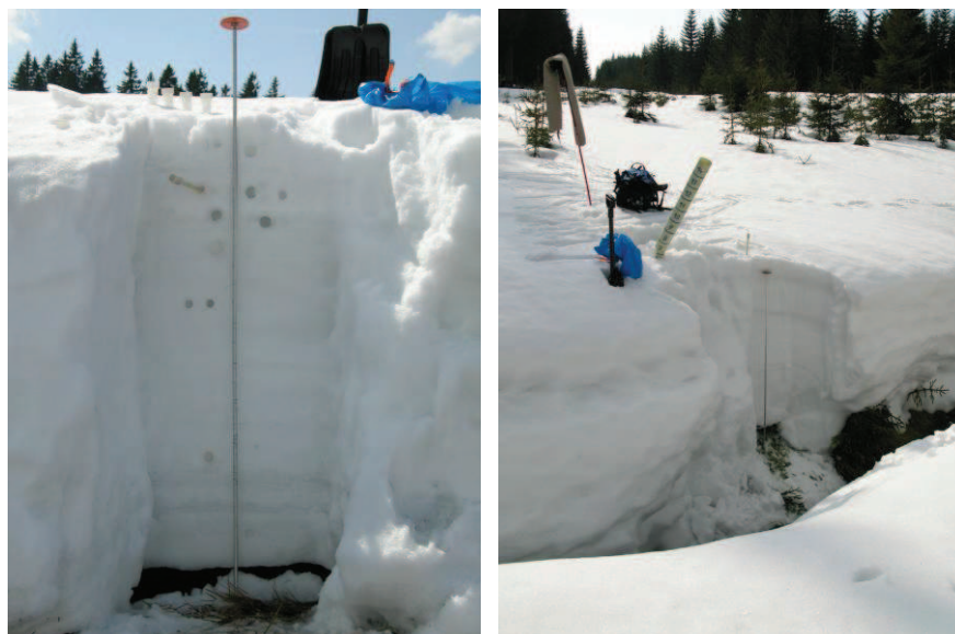
Obr. 40 Vertikální profily sněhové pokrývky v experimentálních profilech Rokytky (vlevo) a Ptačího potoka (vpravo; Pospíšil, 2009)
