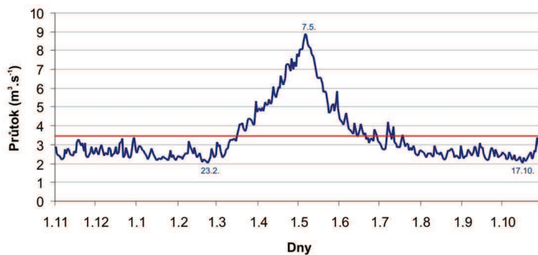
Obr. 44 Vývoj průměrných denních průtoků v profilu Vydra-Modrava v období 1.11.1930-31.10.2008 (Čurda, 2009; upraveno; data ČHMÚ, bez chybějícího období 1.11.1940-31.10.1948)
