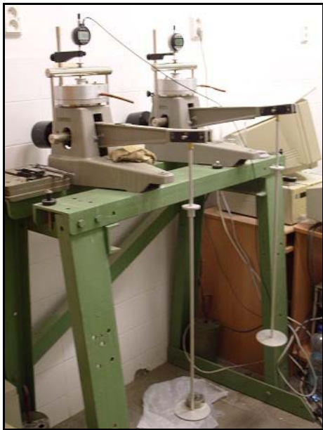
Obr. 3.6 Oedometry v laboratoři mechaniky zemin UK v Praze se zatěžovacím ramenem a hodinkami, na kterých byly prováděny zkoušky.
