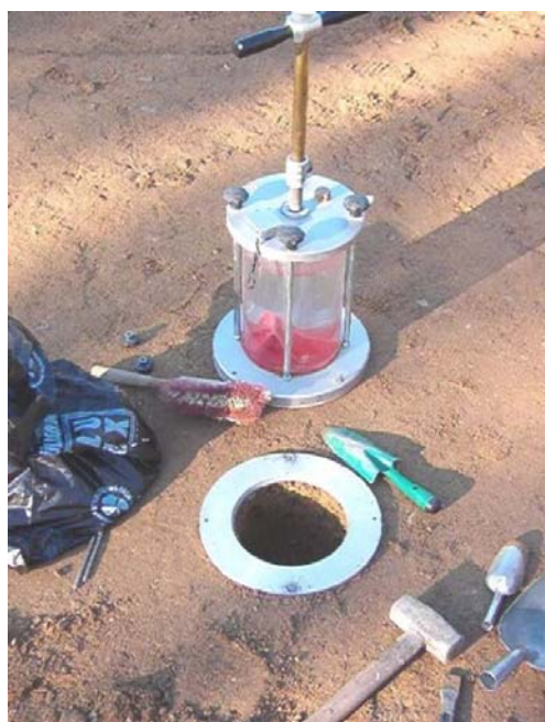
Obr. 3.2 Membránový objemoměr - kovový podstavec ohraničuje jamku vzniklou po odebrání zkoumaného materiálu (Consultest s.r.o., 2006)
