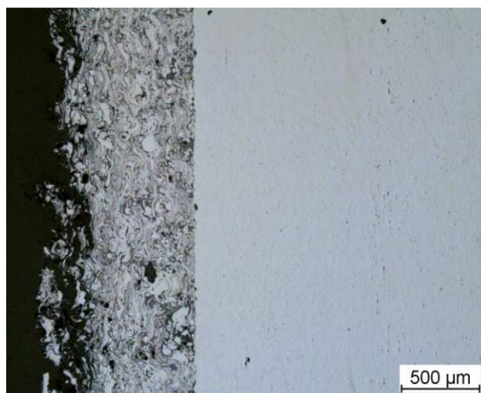
Obrázek 4.7. Plazmový nástřik oceli 316, celkový pohled
