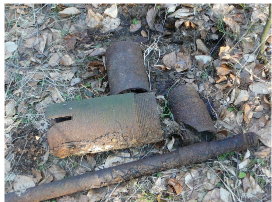
Obr. 28. a 29 Na jednom z míst určených pro vrtnou soupravu lze najít tyto zbytky vrtných korunek.
