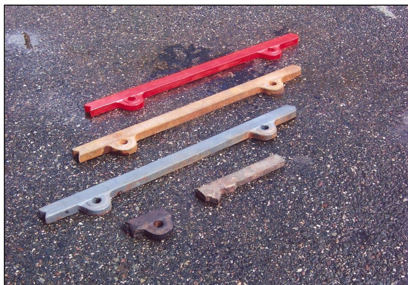
Obrázek 25: Tyčové kolejnice s oušky (foto Jan Lisý, poskytl Muzeum TGM - Lány)
