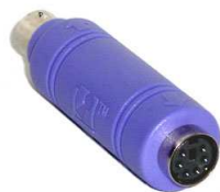
Obr.9: Hardwarový keylogger Zdroj: http://www-cs-faculty.stanford.edu
