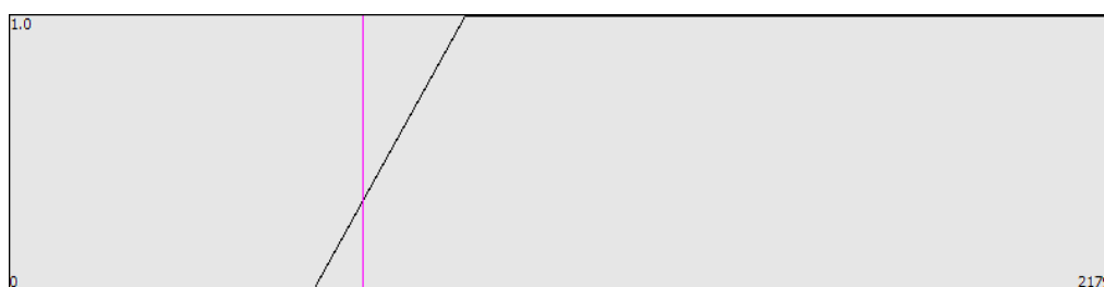
Obrázek 4-9: Nastavení přechodové funkce při třetím testu. Funkce obsahuje lineární přechod mezi hodnotami 600 a 900. V hodnotě 700 je umístěna hranice neprostupnosti
