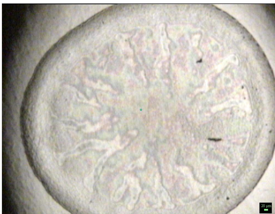
Obr.4.1.2 – Kapka DPPC připravená ve fosfátovém pufru za teploty 50°C následně dialyzovaná. Kapka je zobrazena objektivem zvětšujícím 5x. Na okraji je patrný efekt kávového kroužku.
