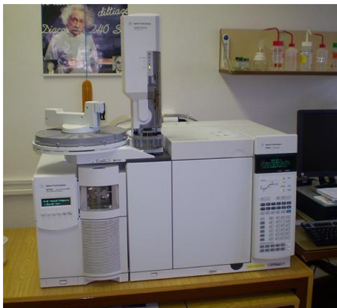
Obr. 2. Plynový chromatograf Výzkumné laboratoře kliniky gerontologické a metabolické, Fakultní nemocnice Hradec Králové.
