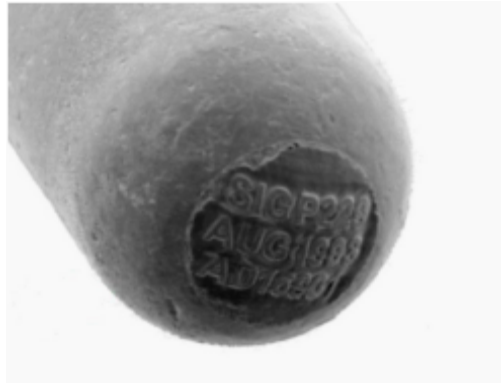
Obr.12 : Hrot zápalníka označený technológiou nanotag
