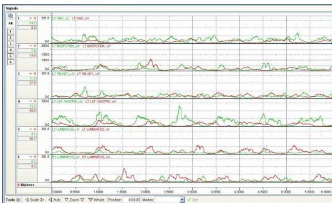
Obrázek 9 – Ukázka šesti cyklistických kroků (rektifikovaný EMG záznam)
