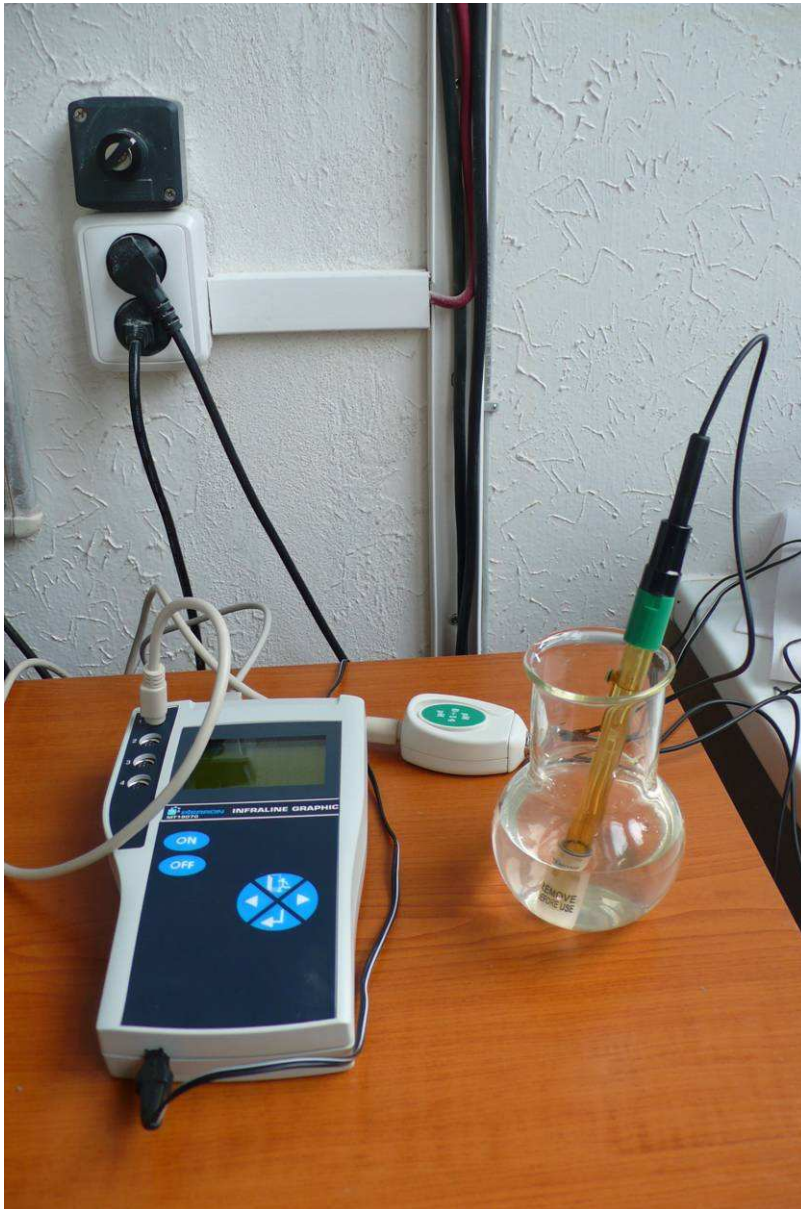
Foto 20: Zapojení dataloggeru pro měření pH
