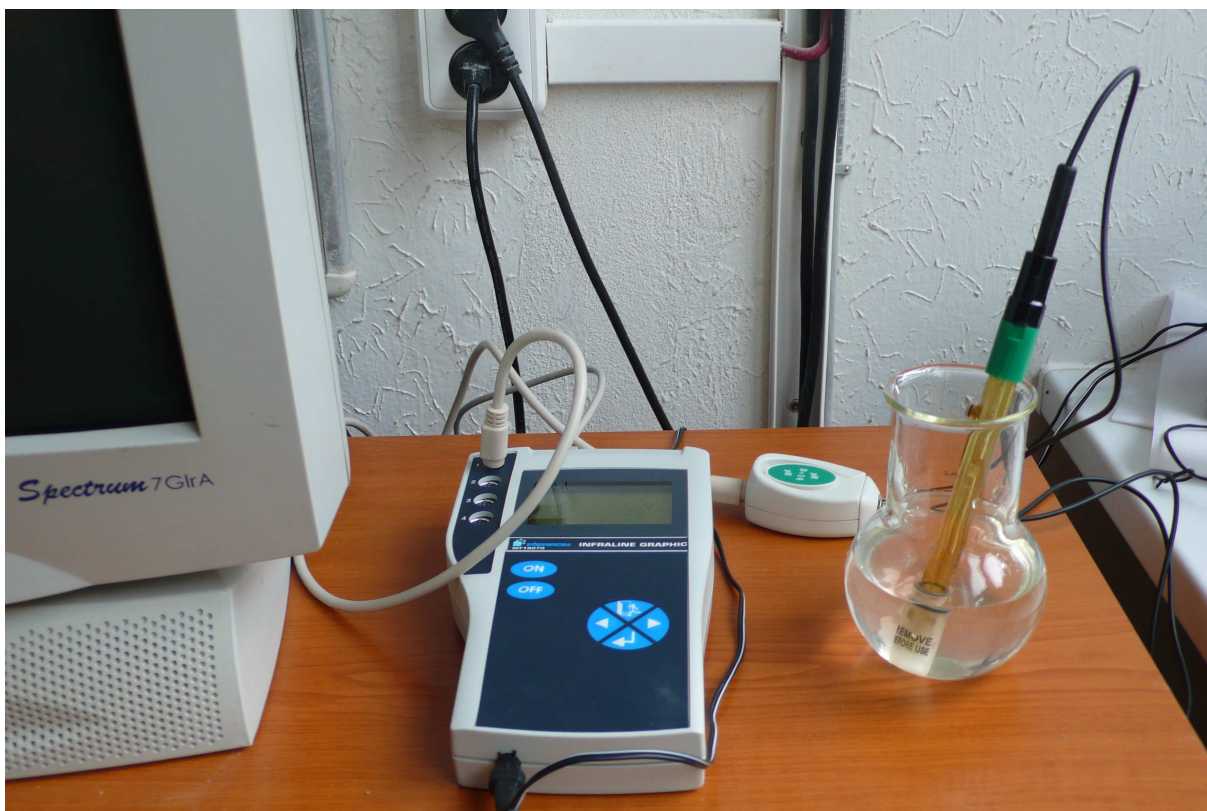
Foto 11: Využití dataloggeru Infraline Graphic v analytické chemii
