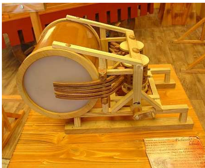
Obr. 2 Model mechanického bubínku, který sloužil k oslavám, vytvořeného podle návrhu Leonarda da Vinci.
