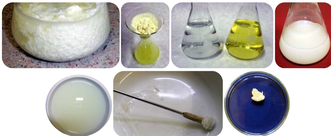
Obr. 16: Průběh extrakce a její výsledek (extrakce - 1. filtrace – Carrezovo činidlo I a II - 2. filtrát - krystalizace - získaný inulin)
