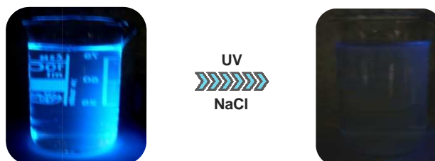
Obr. 13: Tonik pod UV lampou před přidáním roztoku NaCl (vlevo) a po jeho přidání (vpravo)
