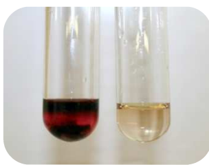
Obr. 19: Roztok inulinu po Selivanově zkoušce (vlevo) a před zkouškou (vpravo)
