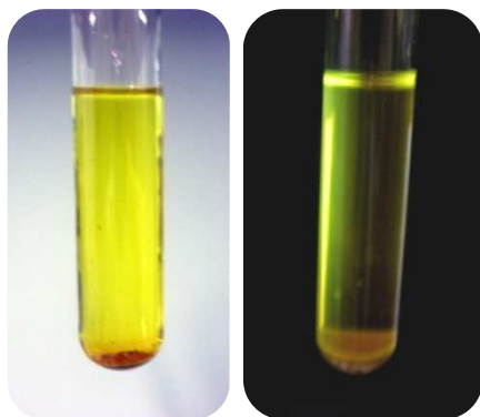
Obr. 30: Fluorescence roztoku kari na běžném světle (vlevo) a pod UV lampou (vpravo; \lambda = 366 \text{ nm} )
