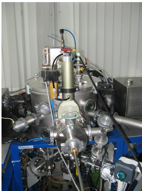
Obr. 3.2: Fotografia depozičnej aparátúry pre sériu vzoriek nyl.
