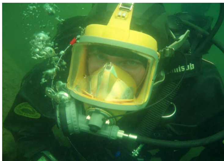
Obrázek 6 - Celobličejevá maska Interspiro Divator MK II (Lehký, 2009)
