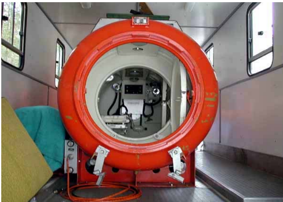
Obrázek 16 - Mobilní dekompresní komora DK - 2 (URL 5 )
