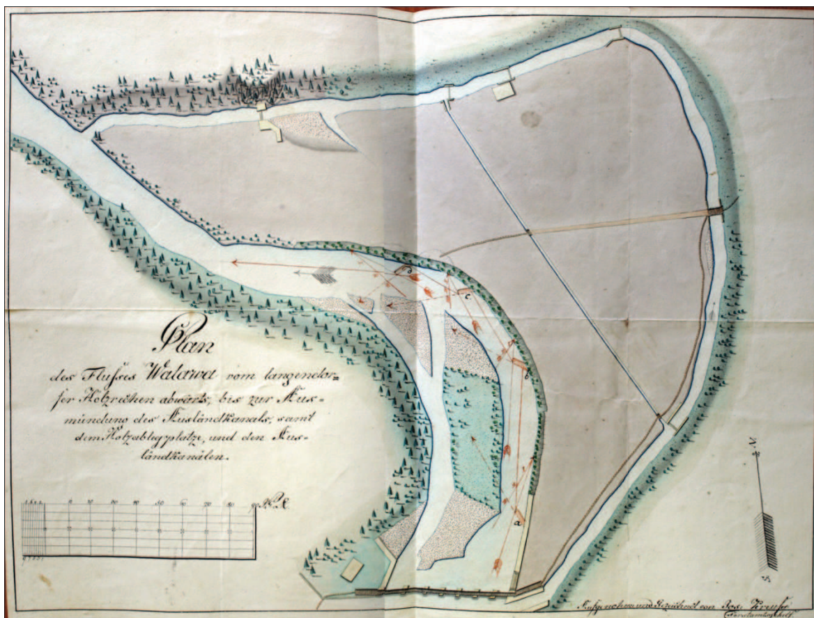
Obr. 23: Plán úprav skladiště dříví a vaziště vorů v Dlouhé Vsi v roce 1836. Ve spodní části jsou patrné rehle, zachytávající plavené dříví. Před nimi odbočka do umělého kanálu, který obtéká celý prostor. (SOA Třeboň, pracoviště Český Krumlov, ústřední schwarzenberská kancelář, střední oddělení, velkostatek Prášily, příloha A6Wα, 5b).
