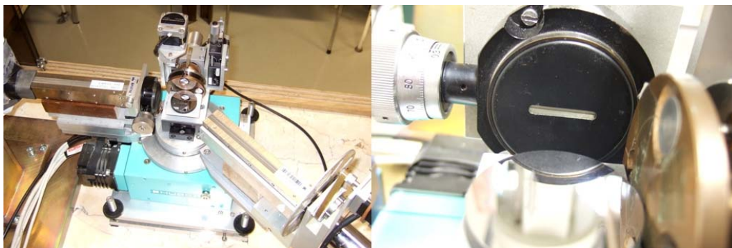
Obrázek 4.8: Umístění vzorku (vlevo) a detail štěrbin S1 před vzorkem (vpravo).
