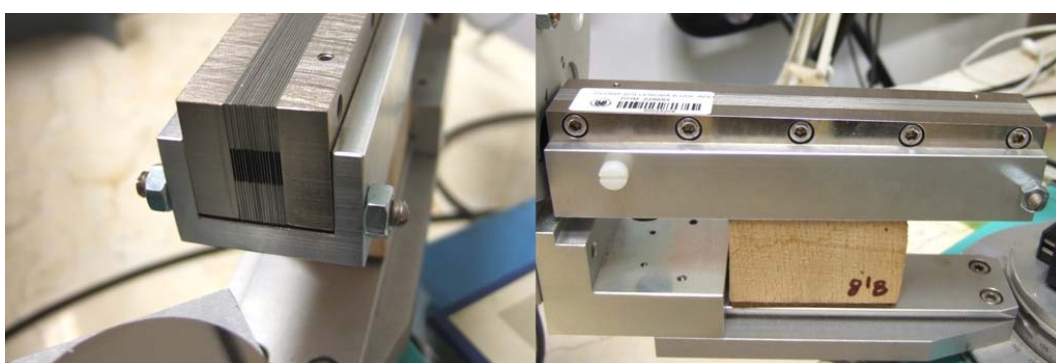
Obrázek 4.9: Detail vstupního okénka Sollerovy clony 2 (vlevo) a celkový pohled tuto clonu se zdvihnutým zadním koncem (vpravo).
