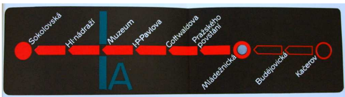
Obr. 18 – Podélné značení linky trasy linky C. Stanice, ze kterých vlak přijíždí, jsou na trase označeny nevýrazně a s názvem stanice ve spodní části schématu. Reprofoto bylo použito s laskavým svolením Archivu Dopravního podniku hl. města Prahy. Dopravní podnik hl. města Prahy - Metroprojekt. Metro Informační systém : katalog značek . Praha : [s.n.], květen 1973.
