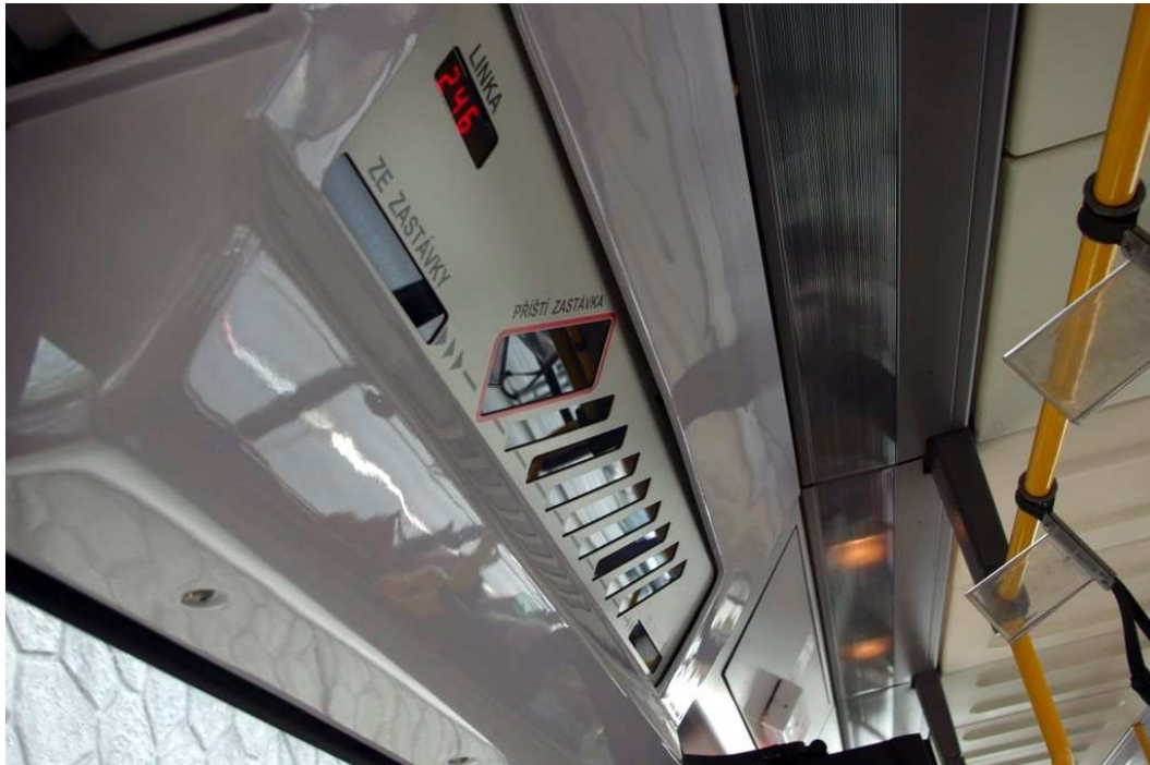
Obr. 9 – Elektronické zobrazovací zařízení polohy v autobusech Dopravního podniku Praha. Duben 2011. Zařízení poskytuje zhoršenou viditelnost v nepříznivých podmínkách: při pronikání slunce do kabiny dochází k odlesku od zobrazovacího zařízení a při pohledu pod úhlem je informace nečitelná.
