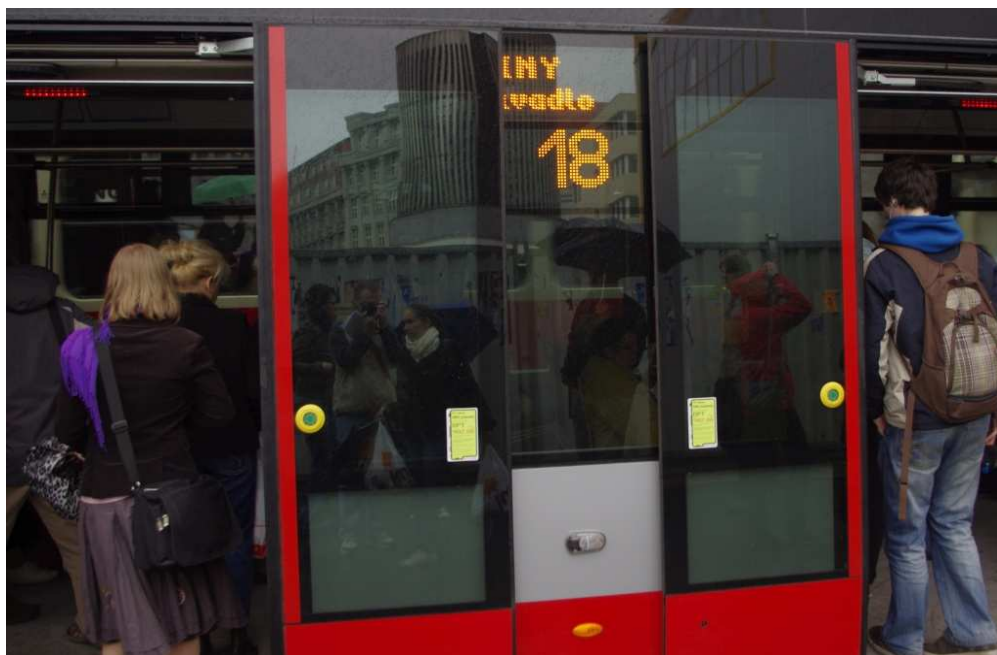
Obr. 8 – Dveřní prostor tramvaje 15T. Praha, duben 2011. Při otevření středních dveří dojde k zapnutí panelu zobrazující číslo linky (18). Zároveň se na panelu horním ukazují konečná a následující zastávky. Text relativně rychle přebíhá, ale přesto tramvaj může odjet, než změní zastávku požadovanou cestujícím.
