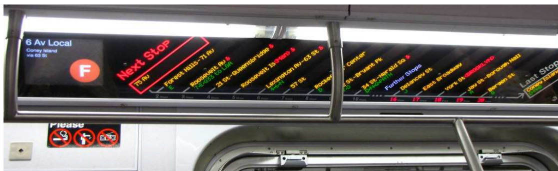
Obr. 10 – Nejnovější typ zobrazovacího zařízení ve vlacích newyorského metra. Červenec 2010. Následujících deset stanic je zobrazeno staticky, následujících pět stanic je označeno čísly a periodicky se střídají. Zobrazeny jsou postupně všechny stanice na dané trase vlaku. Pro další zajímavý příklad zobrazovacího zařízení viz obr. 63 v příloze.
