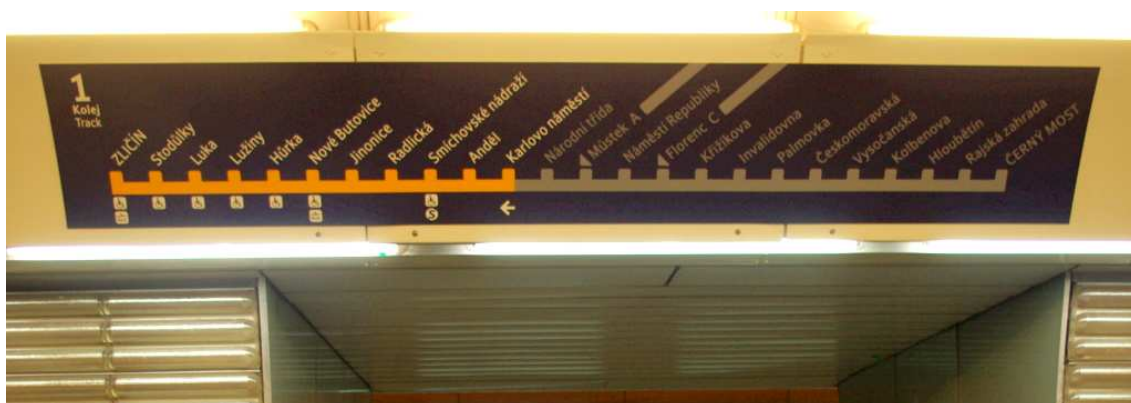
Obr. 53 – Podélné značení ve stanici Karlovo náměstí. Praha, duben 2011. Oproti centrálnímu schématu přibýly symboly přestupů na lince a přístupnosti pro pohybově omezené pasažéry.
