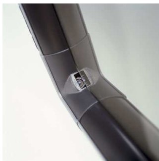
obr. č. 2.7: detail CMOS kamery umístěné v rohu tabule[5]
