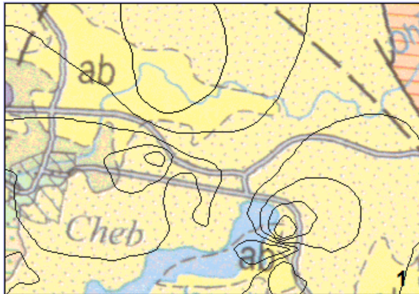
Obr. 2.3. Geologická mapa území s vyznačenými izoliniemi geotermického gradientu, upraveno podle Chába, Stráníka a Eliáše (2007), legenda v příloze P3.
