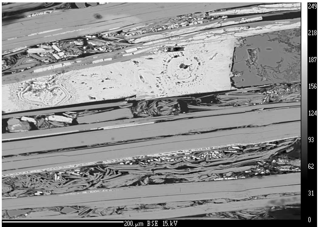
Obr. 7. Celkový pohled na strukturu flogopitu v příčném řezu s koncentrickou inkluzí Fe-minerálu (vz. 3).
