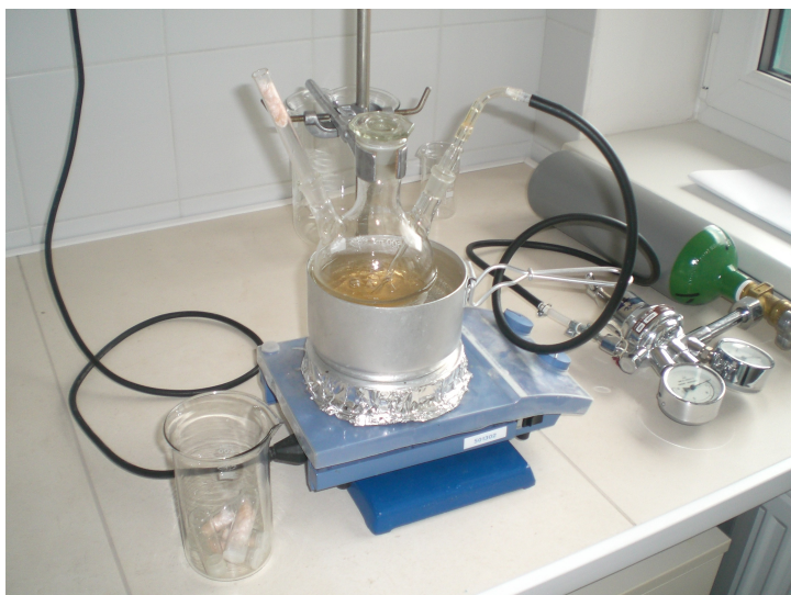
Obr. 10. Aparatura pro zachycení rtuti na amalgamátor (foto J. Buchtová).
