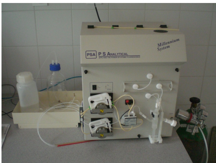
Obr. 8. PS Analytical Millenium Merlin System, GLÚ AV ČR (foto J. Buchtová).
