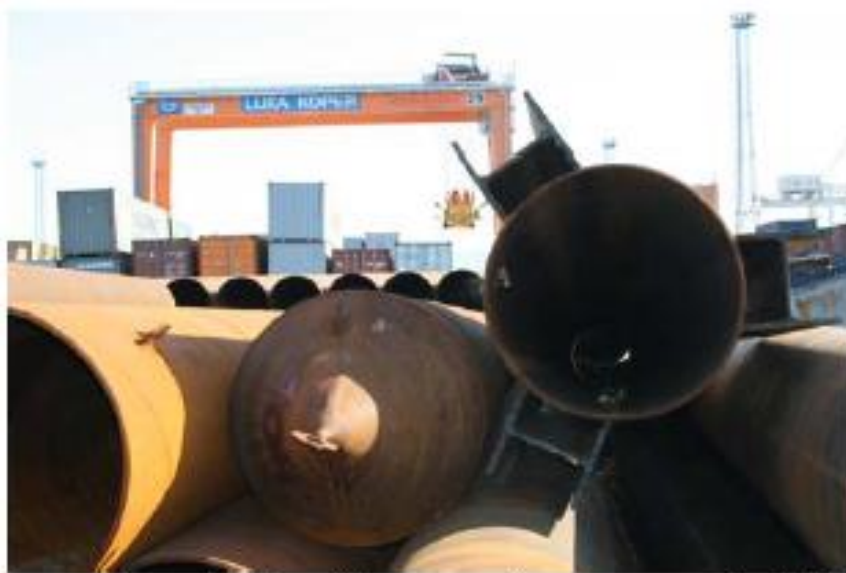
Obr. 15 Duté ocelové piloty s uzavřenou špičkou, průměr 813 mm (foto Logar, 2009)
