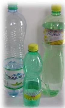
Obr. 57 PET láhve – vyrobeny z polyethyltereftalátu
