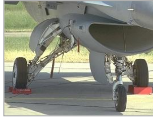
Obr. 80 F-16 Fighting Falcon podvozek – využívají kompozitů s kovovou maticí Obrázek převzat z http://m.gottwald.sweb.cz/f-16/biggear.jpg
