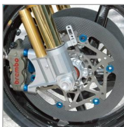
Obr. 82 CMC kompaktní rotor – využívají kompozitů s keramickou maticí Obrázek převzat z http://www.oppracing.com/images/cmsuploads/Large_Images/braketech%20cmc%20rotor%20oppracing%20cbr1000rr.jpg
