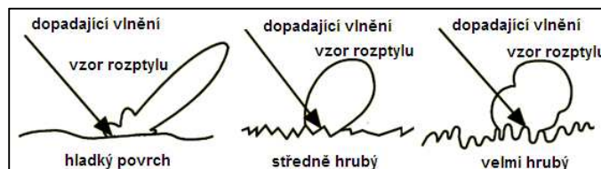
Obr. 6: Vliv členitosti povrchu na rozptyl. (Zdroj: upraveno z Radar Remote Sensing Tutorial.)
