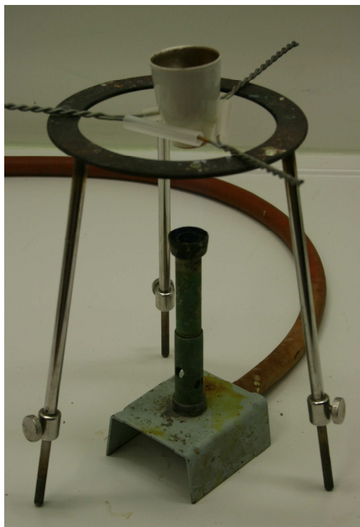
Obr. 43: Stanovení obsahu humusu v půdních vzorcích – aparatura
