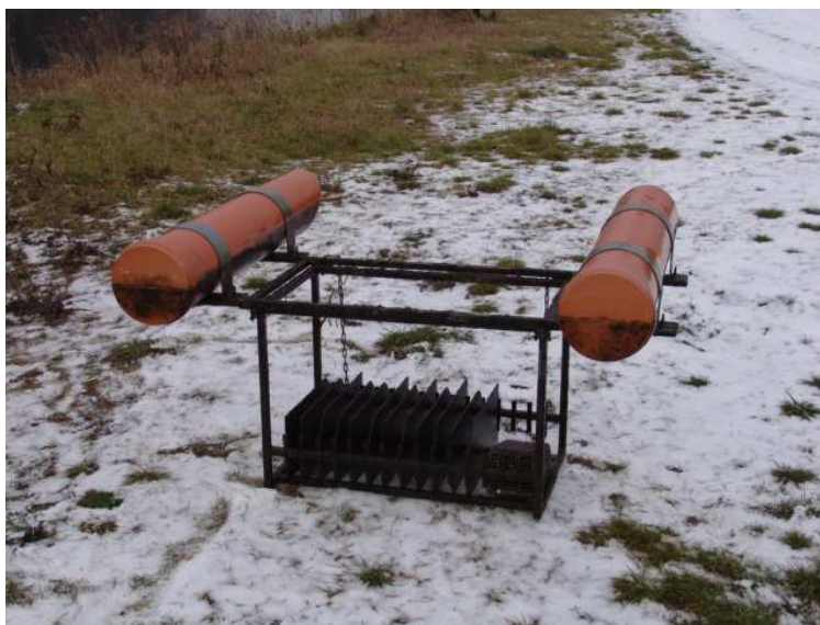
Obr. 6 Plovoucí odběrové zařízení s azbestocementovými deskami (foto: autorka)
