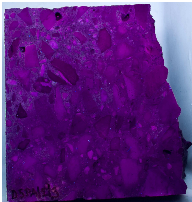
Obr. 12. Vrtné jádro D5PA2 (vlevo) řezná plocha; (vpravo) štěpná plocha - alkalicko-křemičité gely nejsou patrné, svislá strana jádra 148 mm.
