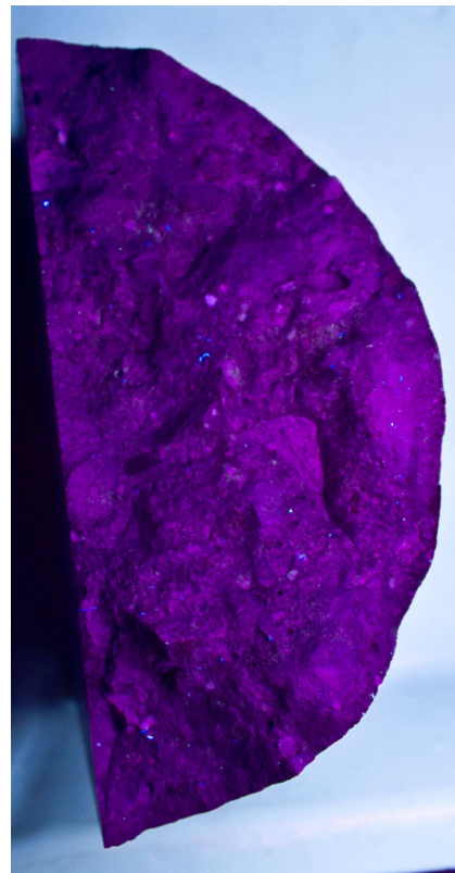
Obr. 12. Vrtné jádro D5PA2 (vlevo) řezná plocha; (vpravo) štěpná plocha - alkalicko-křemičité gely nejsou patrné, svislá strana jádra 148 mm.
