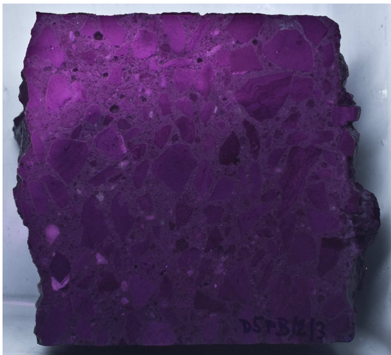
Obr. 13. Vrtné jádro D5PB2 (vlevo) řezná plocha; (vpravo) štěpná plocha - alkalicko-křemičité gely nejsou patrné, svislá strana jádra 148 mm.
