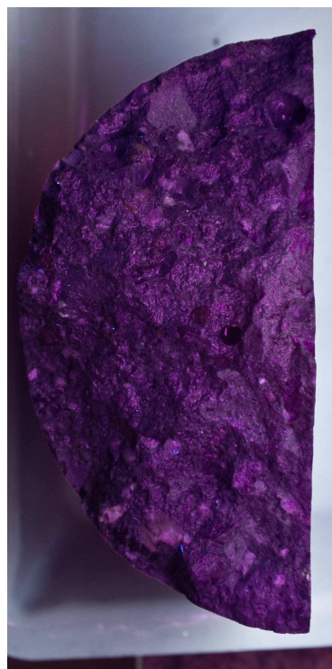
Obr. 13. Vrtné jádro D5PB2 (vlevo) řezná plocha; (vpravo) štěpná plocha - alkalicko-křemičité gely nejsou patrné, svislá strana jádra 148 mm.
