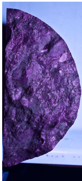
Obr. 14. Vrtné jádro D5PC1 (vlevo) řezná plocha - ojedinělé alkalicko-křemičité gely jsou vidět na kontaktech s kamenivem v pravé části fotografie; (vpravo) štěpná plocha - alkalicko-křemičité gely nejsou patrné, svislá strana jádra 148 mm.
