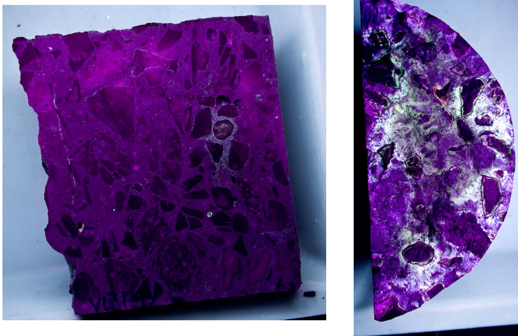
Obr. 10. Vrtné jádro VLP2 (vlevo) řezná plocha; (vpravo) štěpná plocha - alkalicko-křemičité gely tvoří lemy okolo úlomků, vyplňují póry a tvoří celistvý povlak v cementovém pojivu, svislá strana jádra 148 mm.
