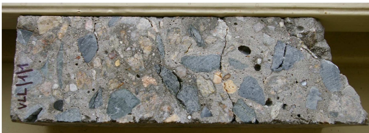
Obr. 7. Trhliny ve vrtném jádře (vrtné jádro VLL1 - odpočívka Vrbova Lhota - 36. km, směr Praha; deska VLL; svislá strana jádra 74 mm; fotografováno 14.3.2008).
